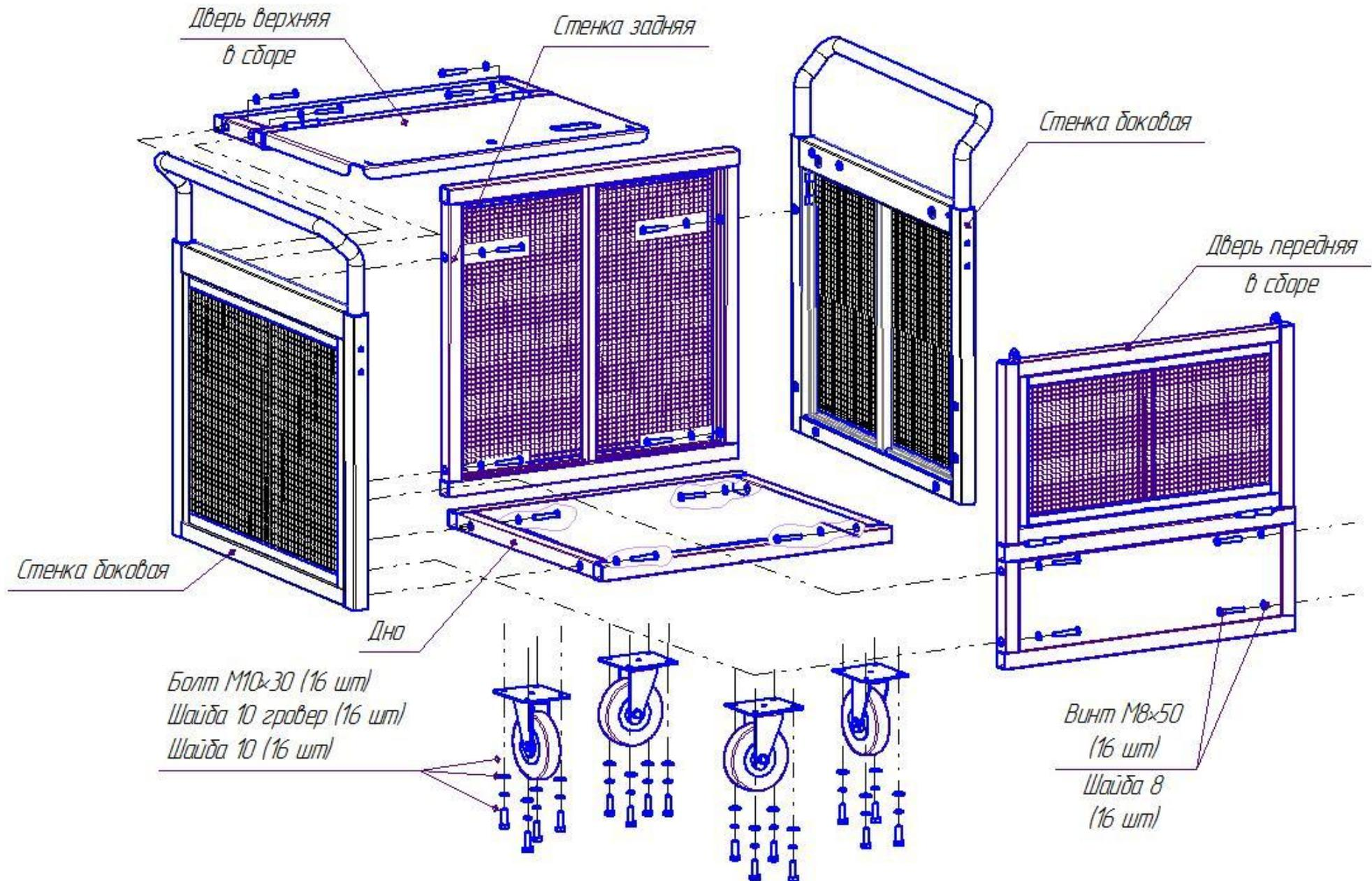
1. Закрепить **Дно** и **Стенки боковые** между собой с помощью 4-х винтов М8х50 и 4-х шайб 8. Винты вставлять с внутренней стороны детали - для всех деталей.
